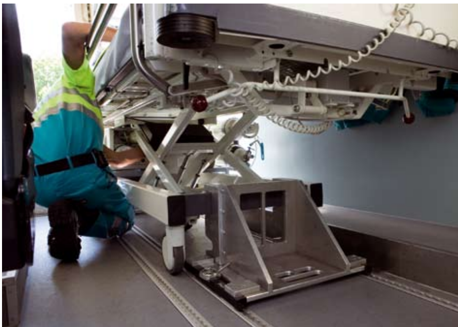
Alle overige apparatuur hangt aan of staat onder de trolley waarmee de patiënt wordt vervoerd.
